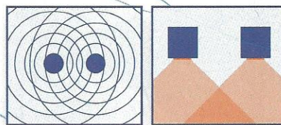
Links die Ausbreitung von Kugelwellen aus Naturschallwandlern, rechts ist (schematisch) „Direktschall“ aus herkömmlichen Musikboxen dargestellt.
